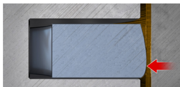
Рис. 3. Рабочая поверхность кольца асимметричной выпуклой формы
