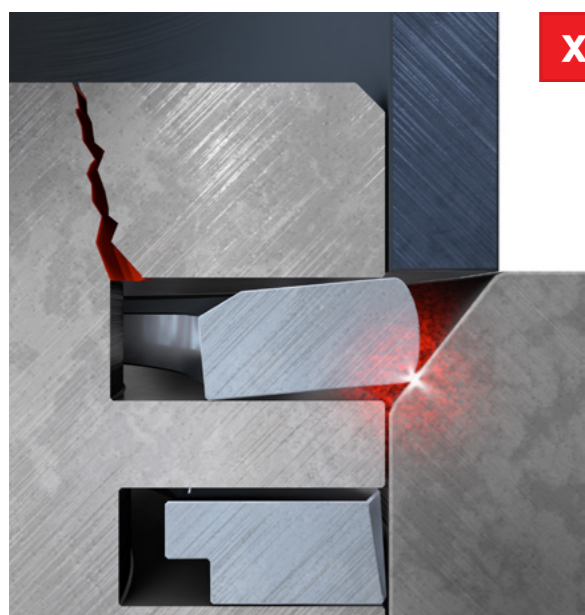
Рис. 1. Слишком большая фаска по краю цилиндра: при монтаже поршневое кольцо зажимается между лентой монтажной оправки и цилиндром, блокируя поршень.
