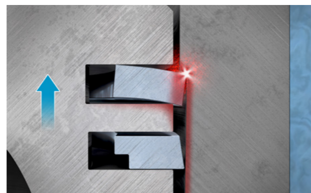
Рис. 3. Удары поршневого кольца нового поршня
