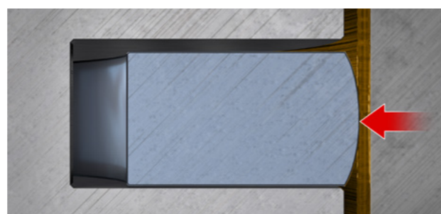
Рис. 2. Рабочая поверхность кольца симметричной выпуклой формы
