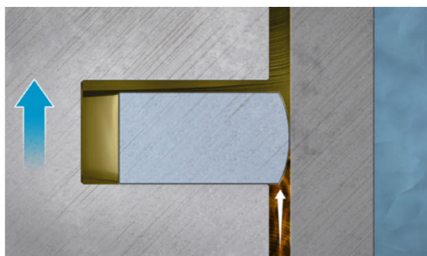
Рис. 1. Уплотнение за счет нижней боковой поверхности канавки
