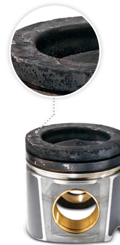
Рис. 3. Слой масляного нагара на жаровом поясе
