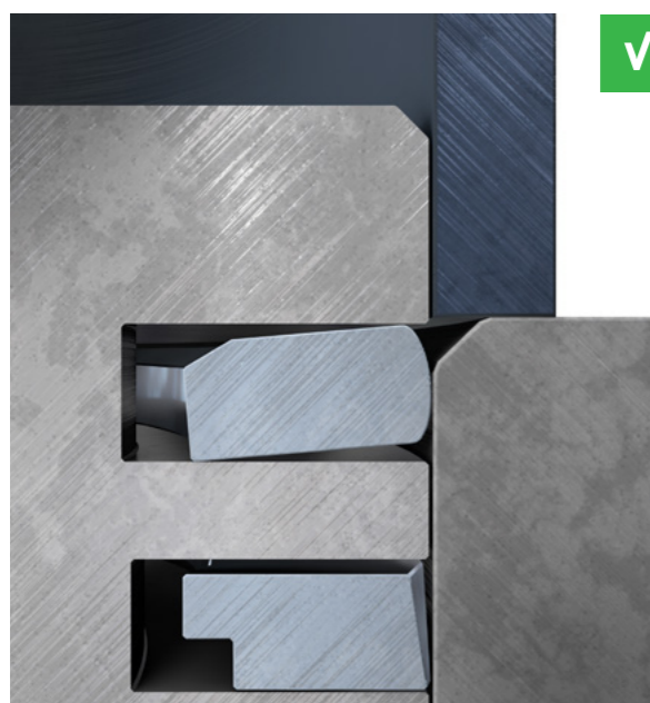
Рис. 2. Фаска небольшого размера по краю цилиндра: поршневое кольцо скользит вдоль зазора.
