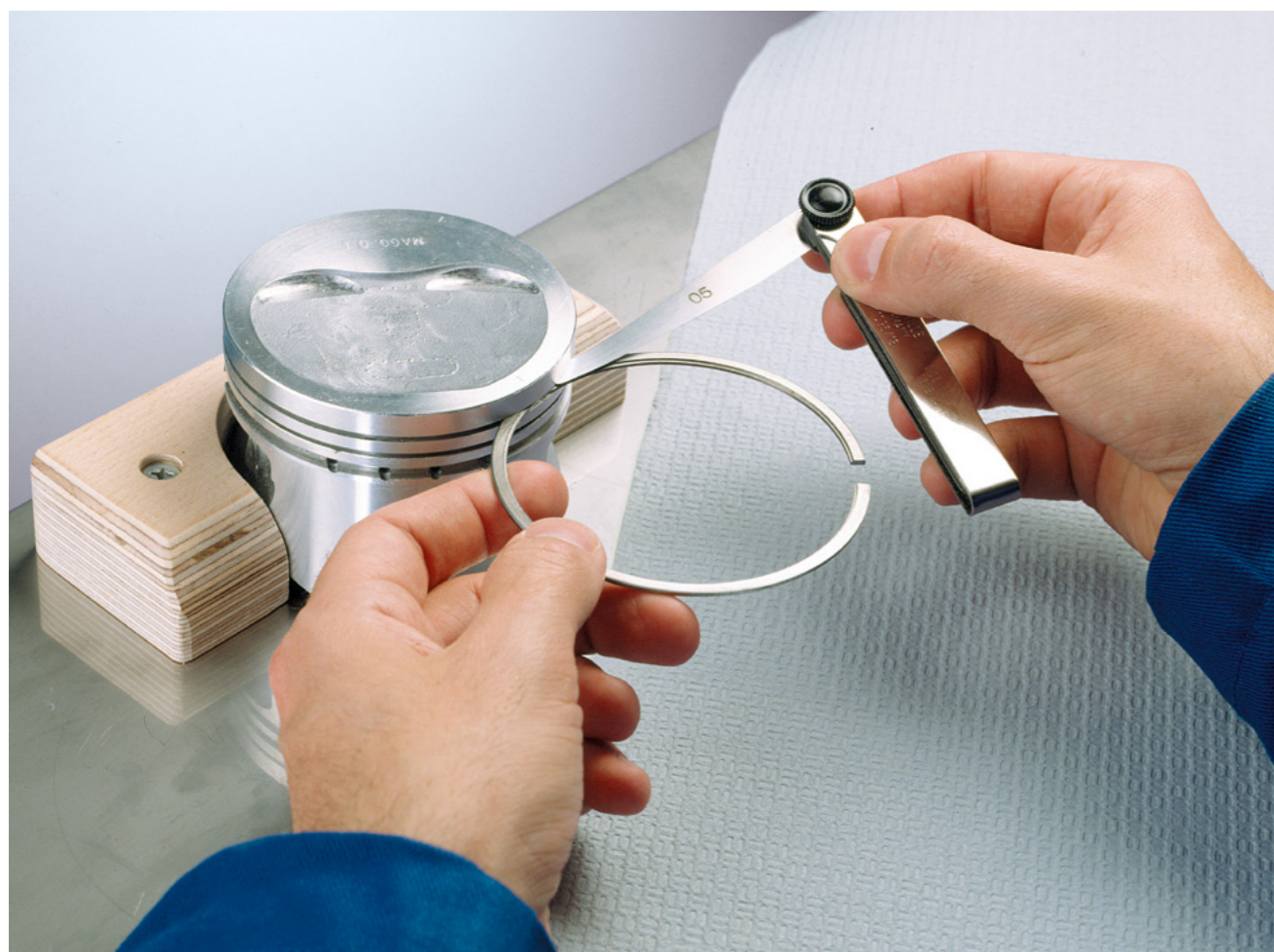
Рис. 1. Измерение зазора кольца по высоте
