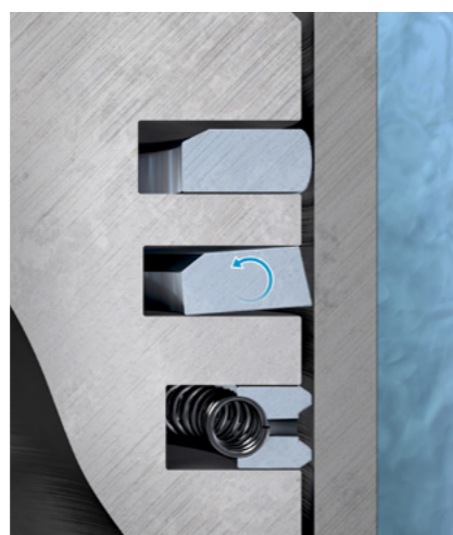
Рис. 3. Положительное скручивание кольца
