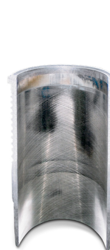
Рис. 2. Блестящие, отполированные места в верхней части цилиндра
