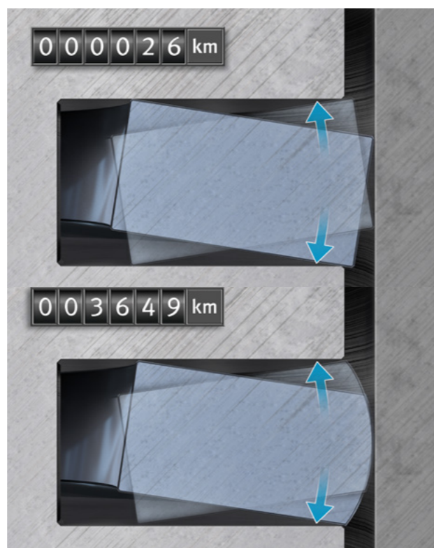
Рис. 1. Образование выпуклости под действием износа в период приработки
